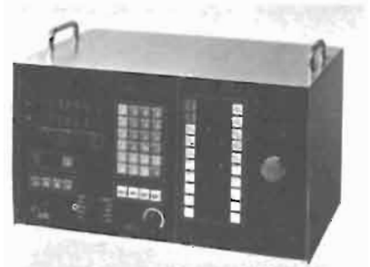
Fig. 10 - Il pannello di controllo MAC 1024 della «CCB srl» di Caronno Pertusella (VA) si adatta in modo particolare a Robot, macchine utensili, manipolatori e simili. Questo «pannello» permette il controllo manuale od automatico entro una vasta gamma di «modi operativi». La programmazione può essere contemporaneamente: a tastiera, da unità periferiche, in autoapprendimento. Il sistema, dotato d'una «ampia RAM di programma» tiene in memoria dieci diversi programmi, oltre alle costanti di lavorazione e taratura. Si possono avere «posizionamenti su tre assi» con encoder incrementali e 4 uscite per il controllo di velocità di lavorazione. 24 ingressi di segnale e 24 uscite di comando ad altrettanti attuatori: valvole, teleruttori ecc. rendono questo complesso elettronico quanto mai interessante e versatile.
