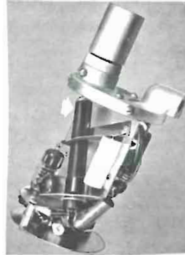
Fig. 5 - Una cella sensibile ai raggi ultravioletti posta in prossimità d'un forno e d'un bruciatore è in grado di discriminare la luce della fiamma dal rosso-vivo delle pareti o delle materie poste nel forno.
